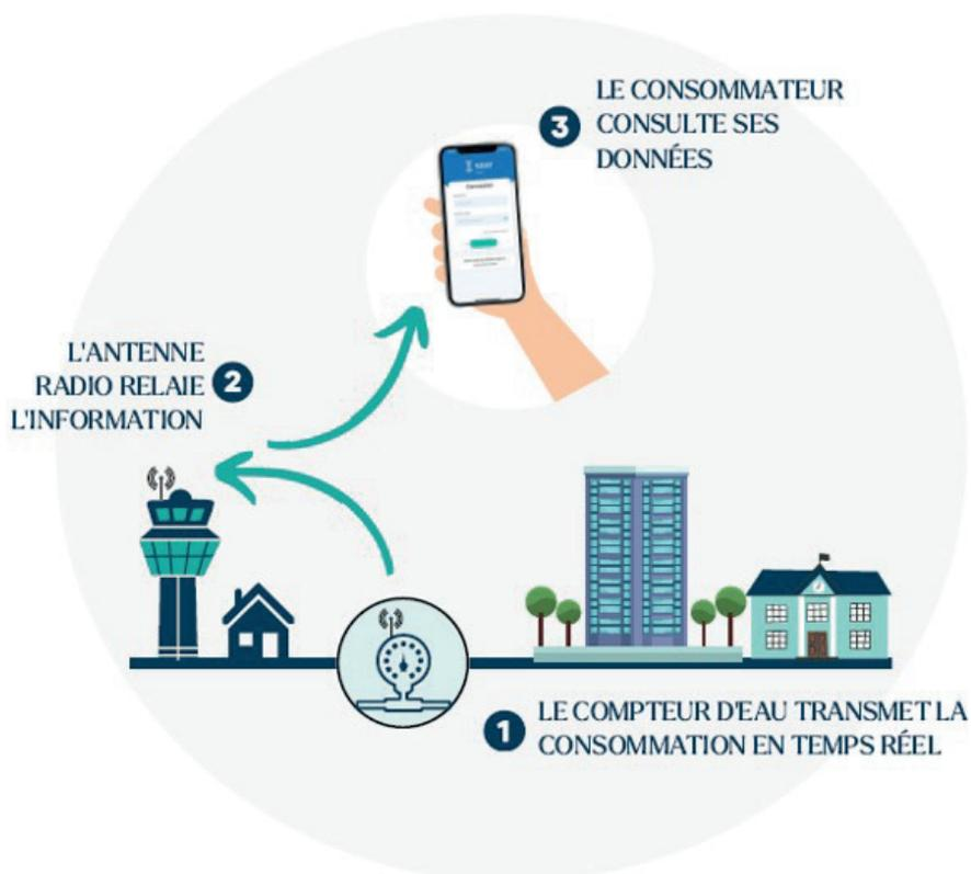
Le module de télérelève du compteur transmet ses données à une antenne relais placée sur un point haut de la commune, qui elle-même renvoie ses données via le réseau mobile classique 4G au serveur de traitement des données, avant mise à disposition sur le site internet ou sur l'application mobile. Les transferts de données sont anonymisés et cryptés.
