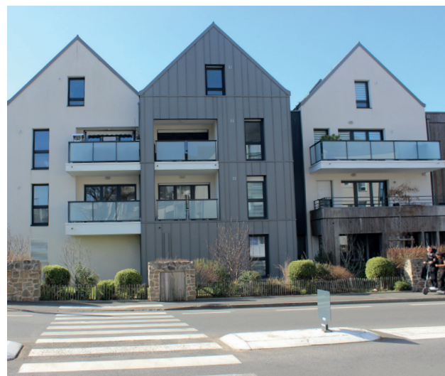
So'Anne, Guérande (Beaulande-Lepage) 2018 Le décalage entre les bâtis et l'alternance de balcons et de loggias permettent de limiter les vis-à-vis. Au rez-de-chaussée, la présence du muret et le traitement paysager permettent de préserver l'intimité des jardinets.
