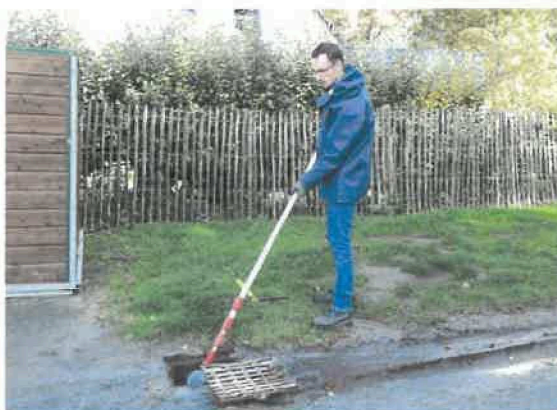
Figure 1 : Prélèvement dans le réseau d’eaux pluviales (en plus des suivis exutoires d’eaux pluviales)
